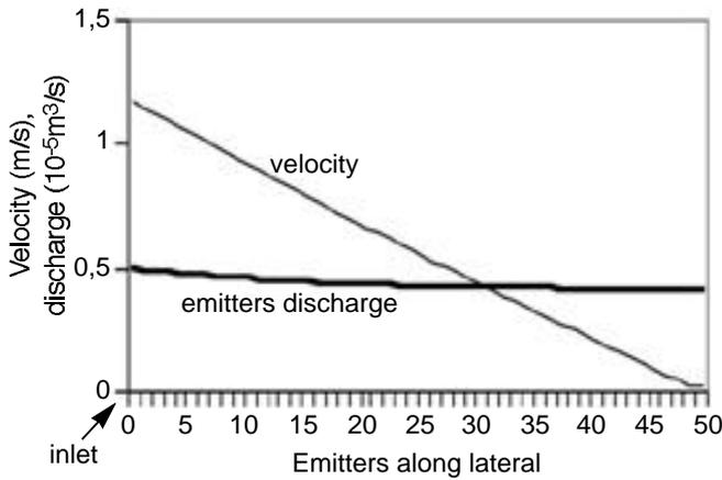
**Figure 2.** Distribution of emitters discharge and velocity (CVM) — *Répartition du débit et de la vitesse (CVM) au niveau des goutteurs.*
