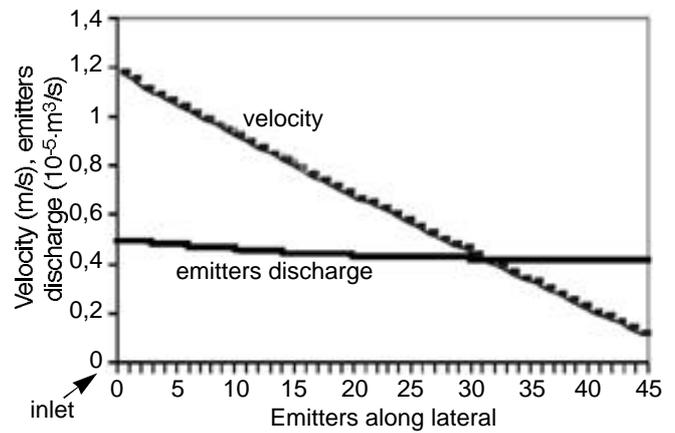
**Figure 4.** Distribution of emitters discharge and velocity along lateral (RK4) — *Répartition du débit et de la vitesse (RK4) au niveau des goutteurs.*
