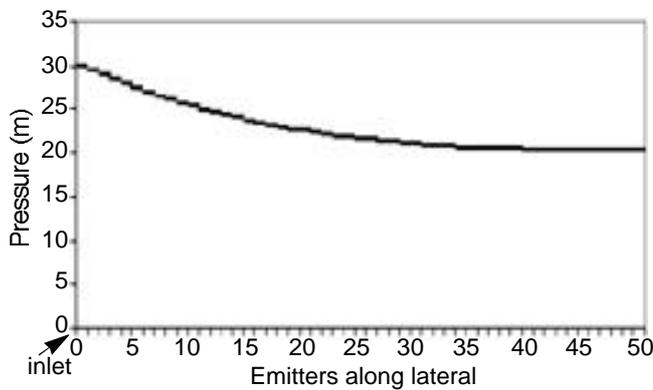
**Figure 3.** Distribution of pressure along lateral (CVM) — *Répartition de la pression au niveau des goutteurs (CVM).*
