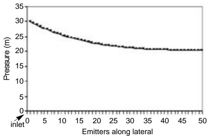
**Figure 5.** Distribution of pressure along lateral (RK4) — *Répartition de la pression au niveau des goutteurs.*
